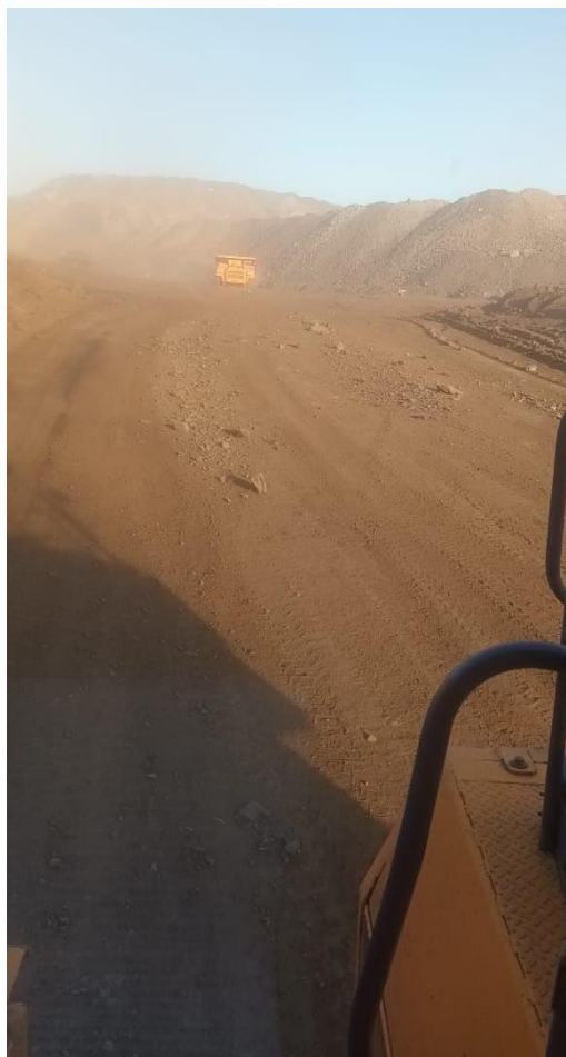
Рис. 4. Просыпи на отдельных участках дороги Fig. 4. Spillages on certain sections of the road
