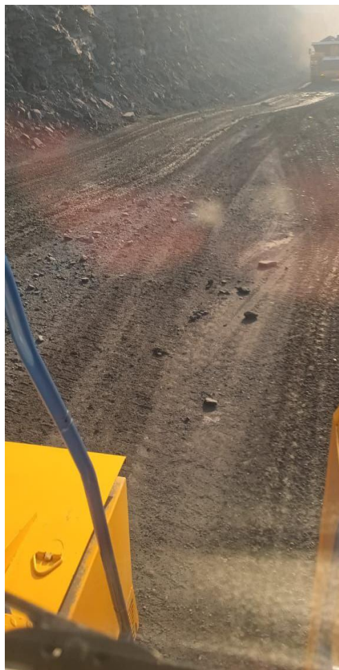
Рис. 4. Просыпи на отдельных участках дороги Fig. 4. Spillages on certain sections of the road
