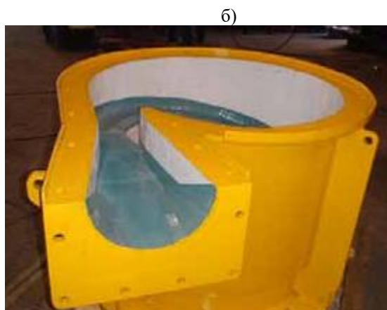
Рис. 1. Зона ввода питания в типовых гидроциклонах а) и аппаратах Cavex б) Fig. 1. Power input zone in typical hydrocyclones a) and Cavex devices b)
