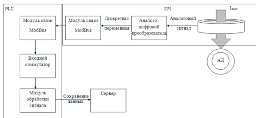
Рис. 3. Функциональная схема фиксации регистрируемых параметров Fig. 3. Functional diagram of recording of registered parameters
