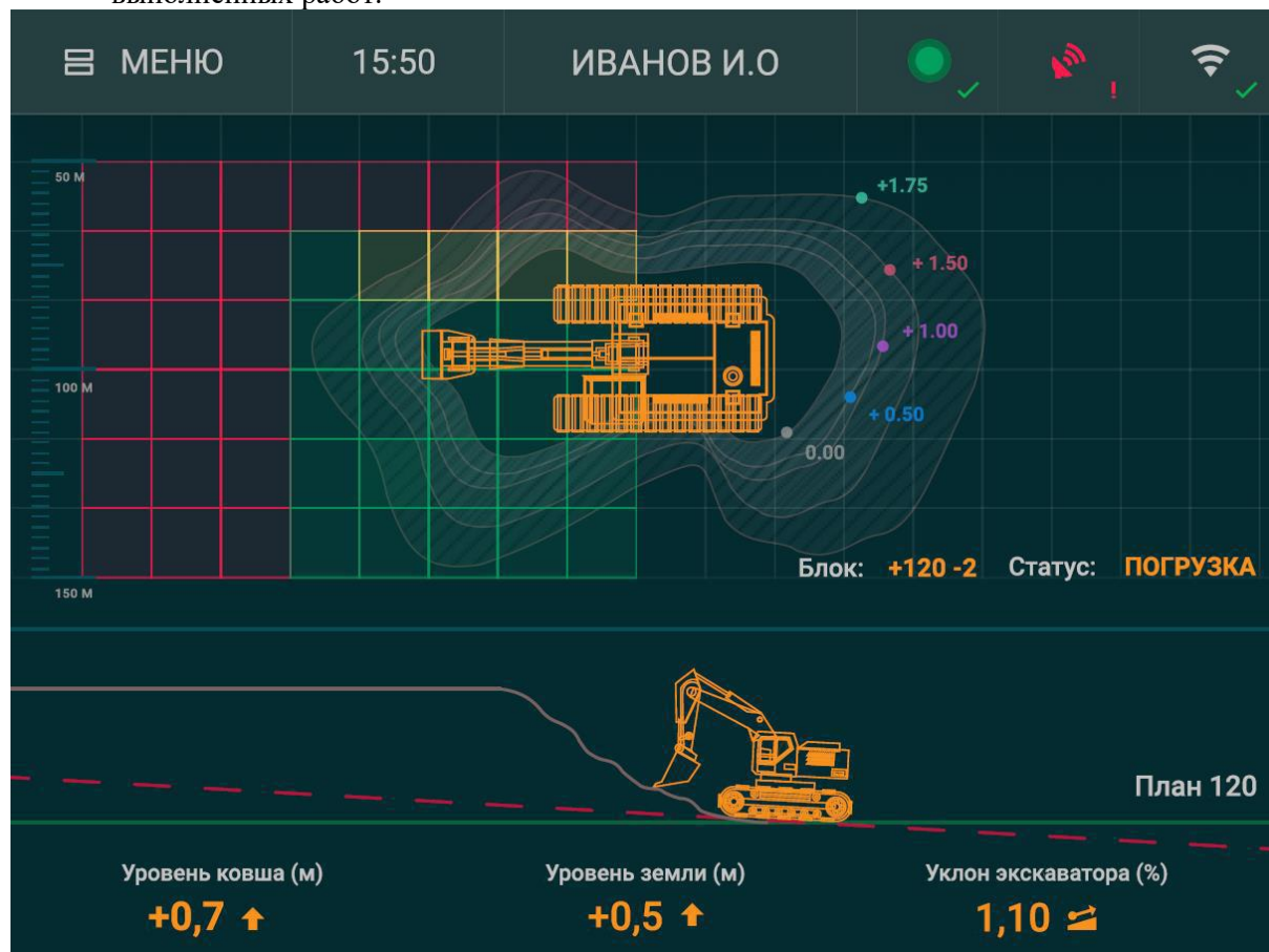
Рис. 7. Информация об отклонении от проектных отметок горизонта Fig. 7. Information on deviations from the design horizontal marks
