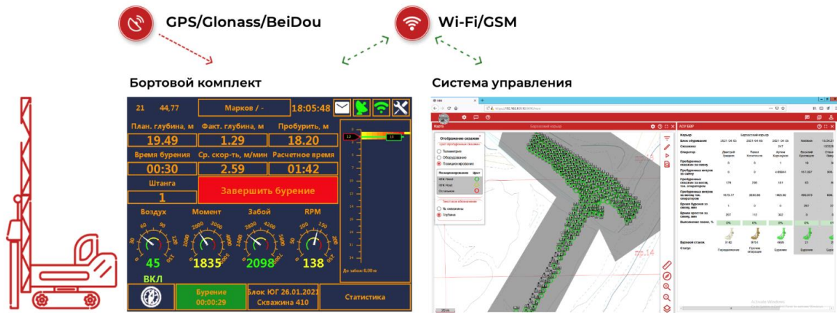
Рис. 3. Принцип работы системы управления буровзрывными работами «DrillManager» Fig. 3. Principle of operation of the DrillManager drilling and blasting control system
