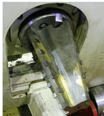
Рис. 7. Законтурный ИО типа фрезы с возможностью поперечного перемещения в законтурном канале
