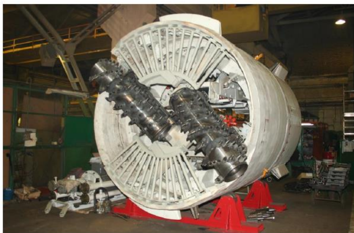
Рис. 1. Опытный образец геохода модели «401» диаметром 3,2 м
