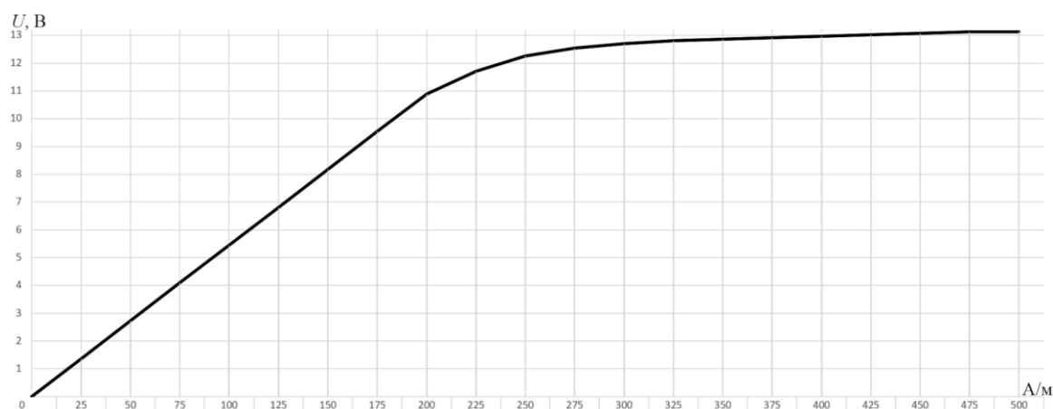
Рис. 2. Функция преобразования ФМЧС без ККП
