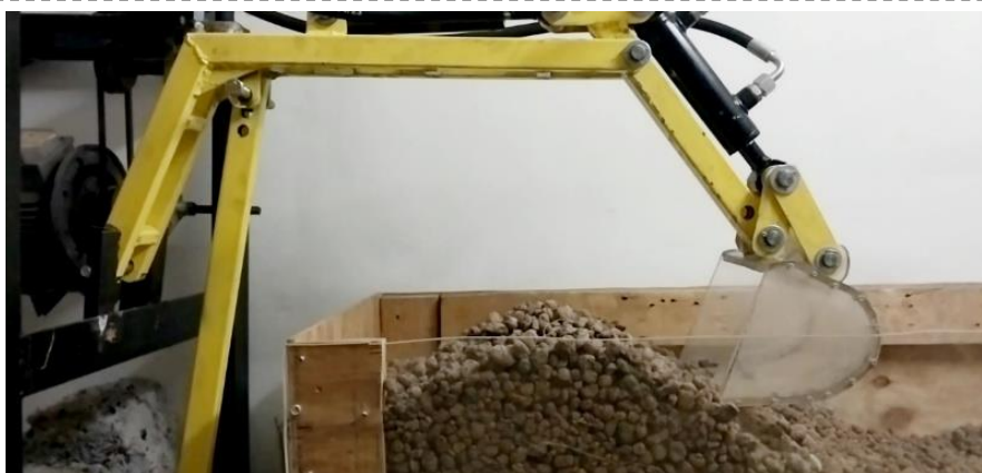
Рис. 1. Лабораторная установка, предназначенная для физического моделирования процесса черпания Fig. 1. Laboratory installation designed for physical modeling of the scooping process
