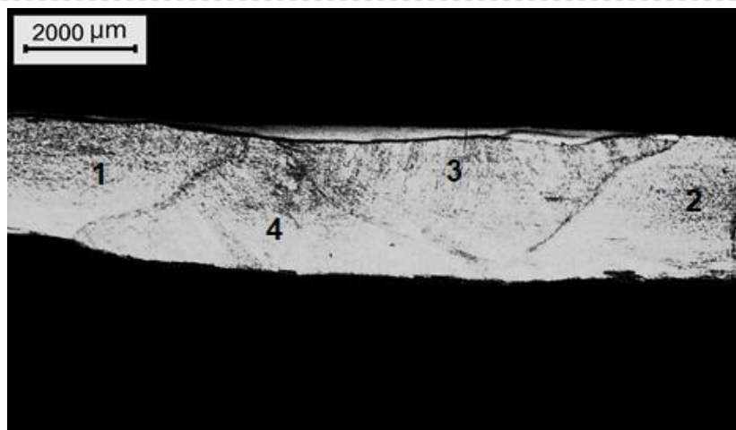
Рис. 2. Макроструктура сварного соединения, выполненного РДС:
