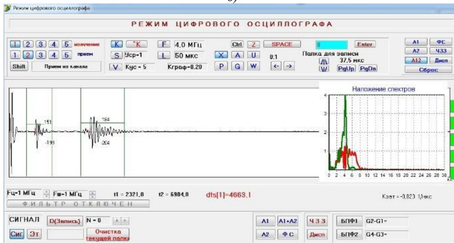
Рис. 2. Внешний вид пользовательского интерфейса специализированного программного обеспечения ИВК «АСТРОН». Сталь 12Х1МФ, состояние: а – исходное (без эксплуатации), б – после длительной эксплуатации более чем 260 тыс. ч без разрушения;
