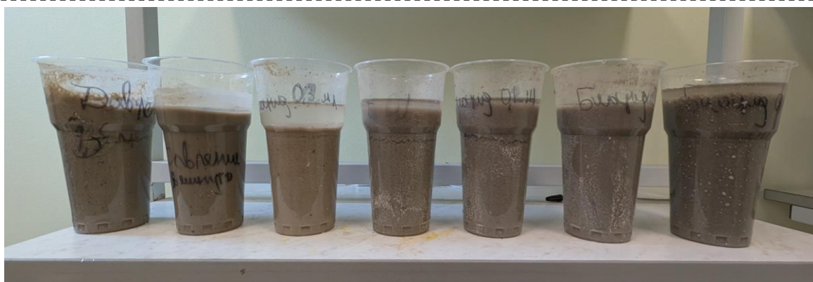
Рис. 2. Внешний вид смеси избыточного ила и флотошлама после различных видов обработки (слева направо): электролиз 90 сек, электролиз 180 сек, ВБАС 0,05 мл/л, ВБАС 0,1 мл/л, ВБАС 0,15 мл/л, комбинация электролиза и ВБАС, ферратная обработка
