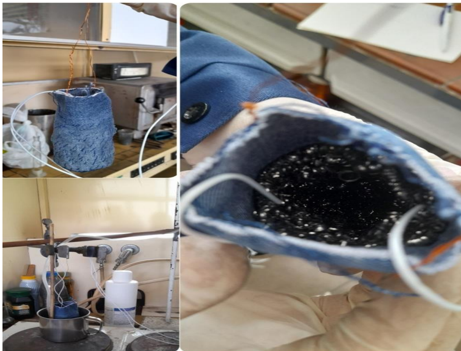
Рис. 2. Анод в виде сборника пылевидного угольного материала Fig. 2. Anode designed as a pulverized coal collector
