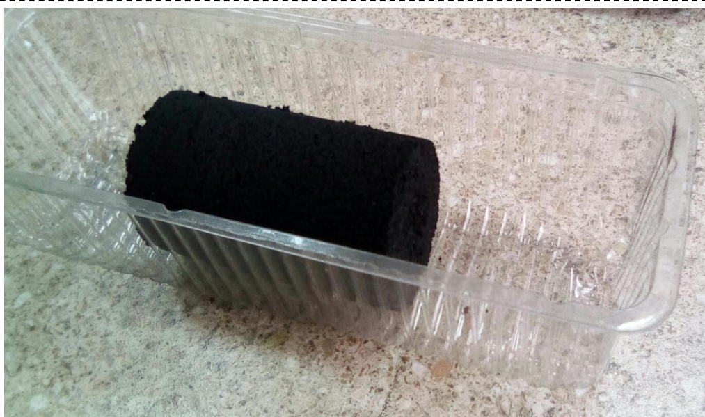
Рис. 1. Анод, полученный брикетированием технического углерода
