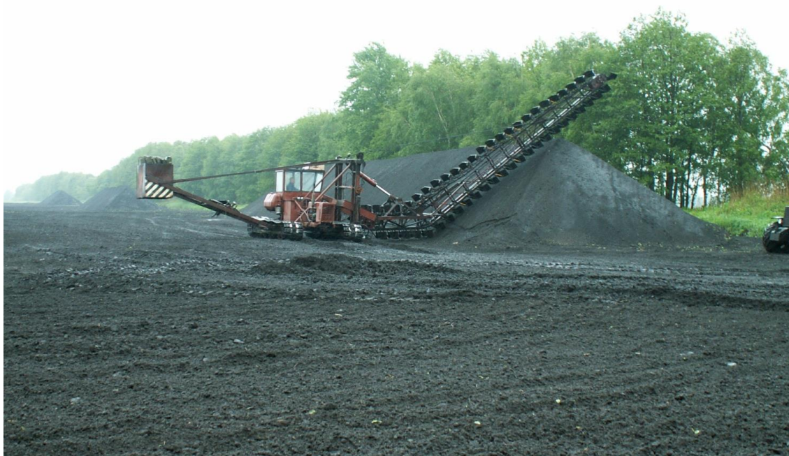
Рис. 7. Фото работы штабелера по формированию складочных единиц фрезерного торфа Fig. 7. Photo showing a stacker forming storage units of milled peat
