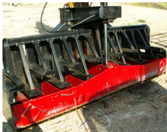
Рис. 3. Специальная насадка на экскаватор для добычи резного торфа
