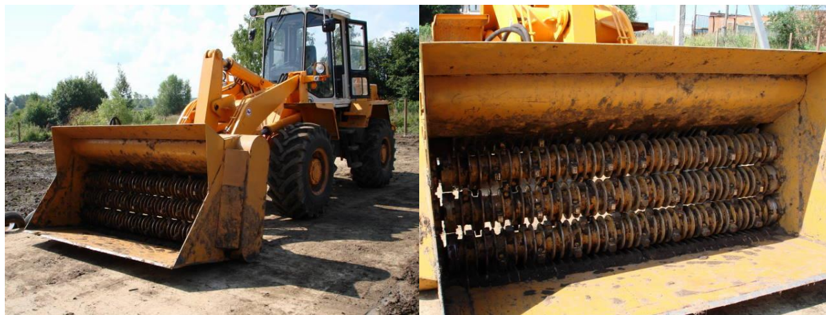
Рис. 11. Колесный погрузчик, оборудованный одним из вариантов ковшовой просеивающей дробилки Fig. 11. Wheel loader equipped with one of the bucket-type screening crusher models
