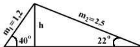
Рис. 16. Схема поперечного сечения штабеля торфа
