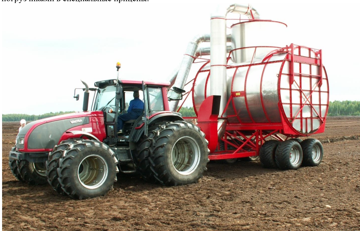
Рис. 5. Фото бункерной уборочной машины с пневматическим принципом сбора торфа из растила
