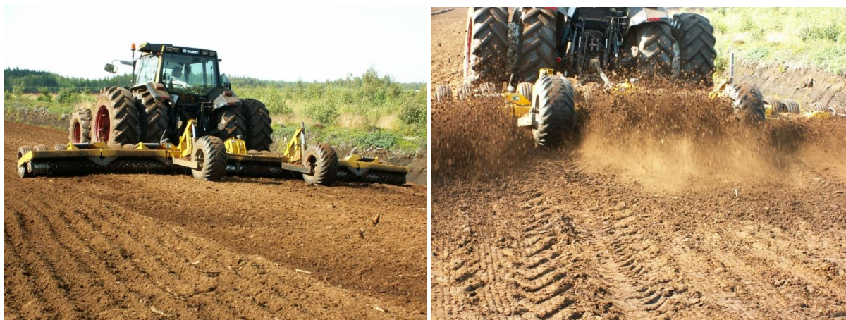
Рис. 4. Фото фрезбарабана, агрегатированного с колесным трактором (слева) и фрезерование торфяной залежи (справа)
