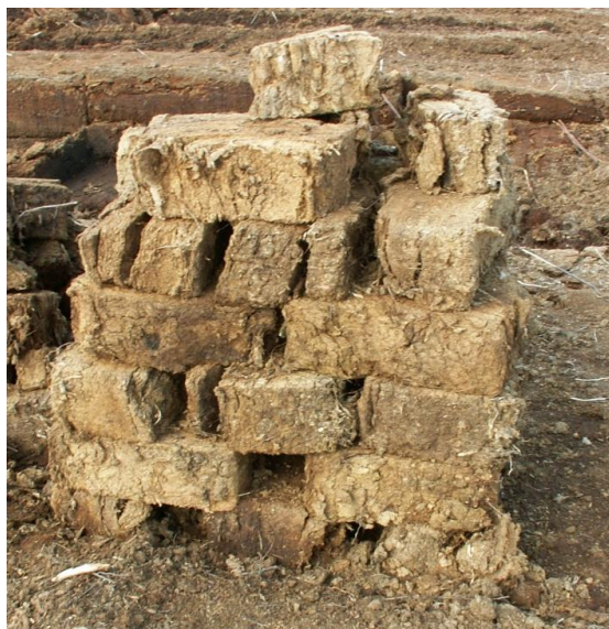
Рис. 2. Современный вариант резного торфа – фигура, выполненная из отдельных кусков («кирпичей») для сушки в естественных условиях
