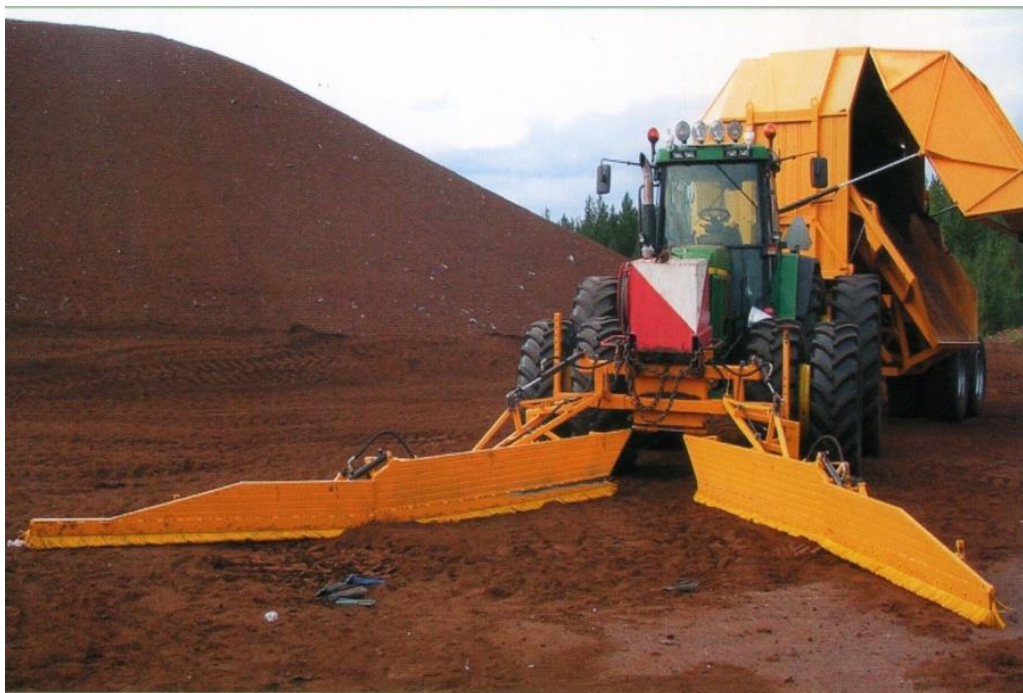
Рис. 6. Бункерная уборочная машина с механическим сбором торфа из валков Fig. 6. Hopper-type harvesting machine with mechanical picking of peat from windrows
