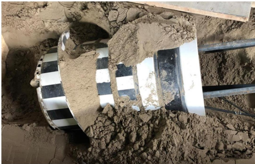
Рис. 3. Демонстрационный образец геохода с НИО выпуклой геликоидной формы Fig. 3. Demonstration model of a geokhod with a convex helical-shaped cutting tool
