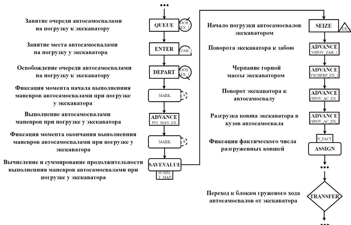
Рис. 6. Модуль «Работа экскаваторов» GPSS-модели участка разреза Fig. 6. Module "Excavator Operation" of the open pit mining site GPSS model
