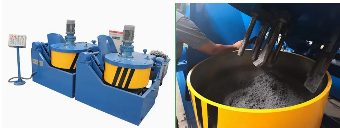
а) б) Рис. 1. Барабанный смеситель для абразивных масс а) общий вид
