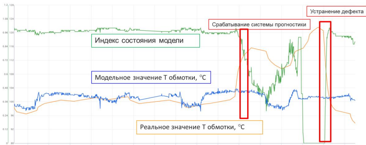
Рис. 3. Опыт эксплуатации. Повышение температуры обмоток ГДК Fig. 3. Operating experience. Increasing the temperature of the gas turbine windings
