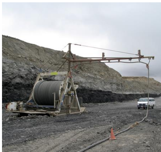
Рис. 1. Кабельные ворота (тип гусак с кабельным барабаном и без) Fig. 1. Cable gates (type of gooseneck with and without a cable drum)
