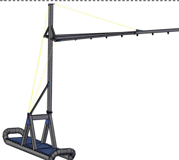
Рис. 1. Кабельные ворота (тип гусак с кабельным барабаном и без) Fig. 1. Cable gates (type of gooseneck with and without a cable drum)
