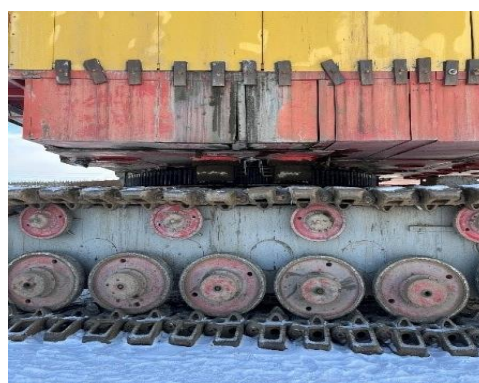
Рис. 3. Сход полотна с ведущей шестерни и полная остановка оборудования Fig. 3. The web comes off the drive gear and the equipment stops completely
