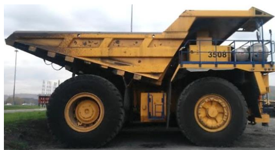
Рис. 3. Газодизельный карьерный самосвал БелАЗ-75131, оснащенный криогенной бортовой топливной системой (1 – криогенные топливные баки объемом 500 и 850 литров)
