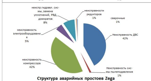
Рис. 4. Сравнительный состав структуры аварийных простоев буровых станков Atlas Copco (A), Sandvik (B) и Zega (C)
