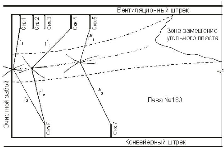
Рис.1. Результаты выявления пространственного расположения нарушения по потенциальному ЕЭП угольного пласта в лаве № 180
