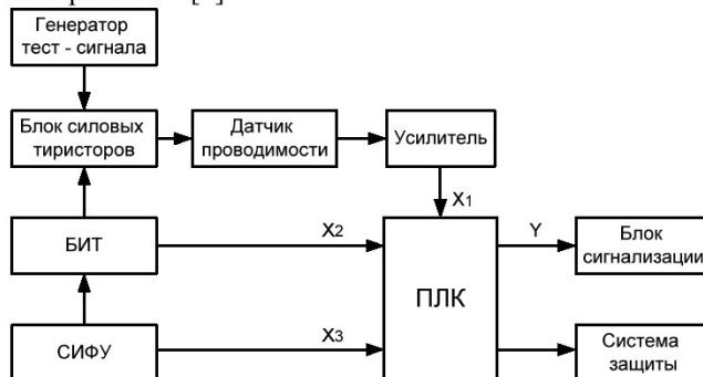
Рис. 3. Функциональная схема контроля состояния тиристоров и блока импульсных трансформаторов
