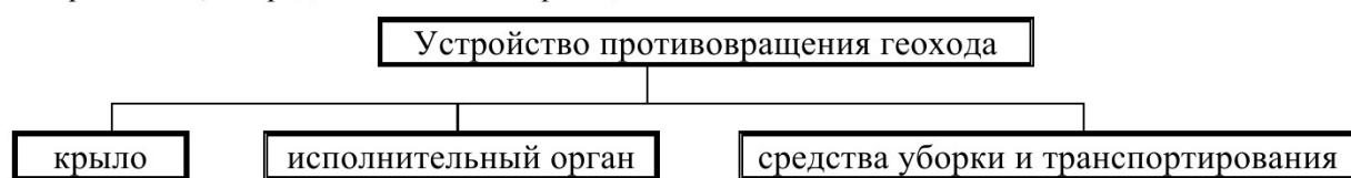
*Рис.1. Система функциональных элементов устройства противовращения геохода*
