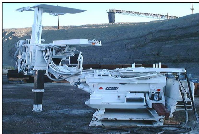
Рис. 5. Комбайн для анкерного крепления «Fletcher»
