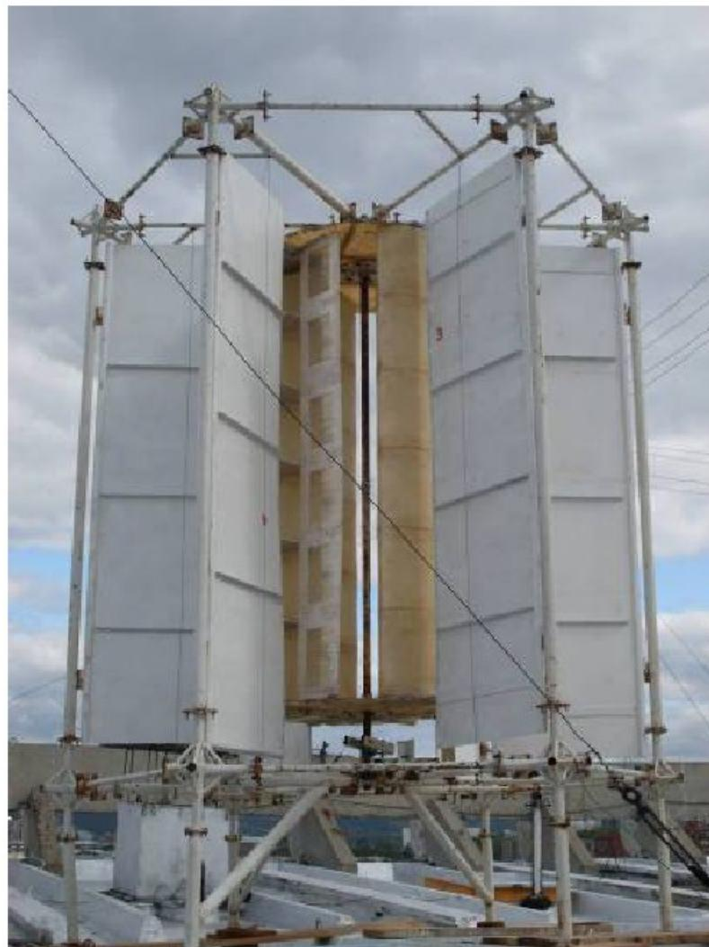
Рис. 1. Общий вид экспериментальной установки с тремя лопастями типа «Колокол»
