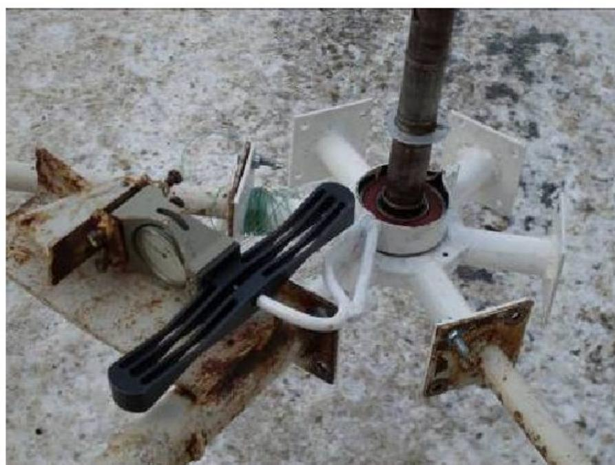
*Рис. 3. Устройство для определения вращающего момента без тормозных колодок:
