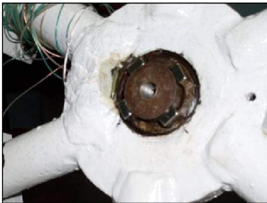
*Рис. 2. Устройство для определения условной скорости вращения вала:
