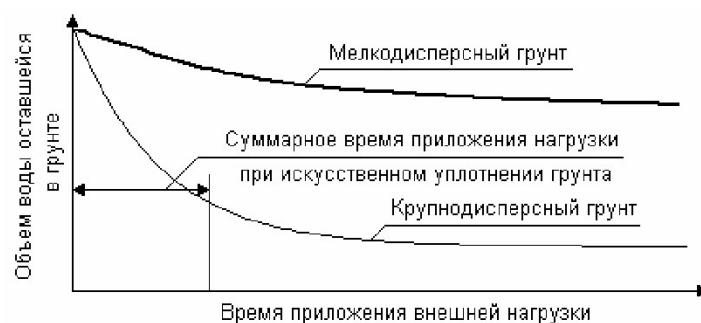
*Рис. 2. Изменение объема воды, оставшейся в грунте, из-за ее оттока из грунта под действием постоянного внешнего давления во времени*
