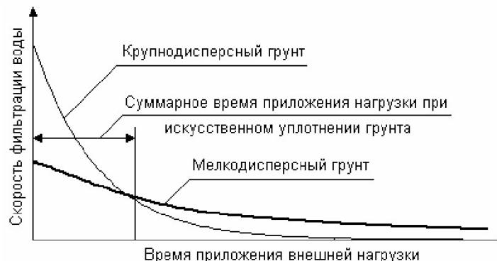
*Рис. 1. Изменение скорости фильтрации воды из-за ее оттока из грунта под действием постоянного внешнего давления во времени*
