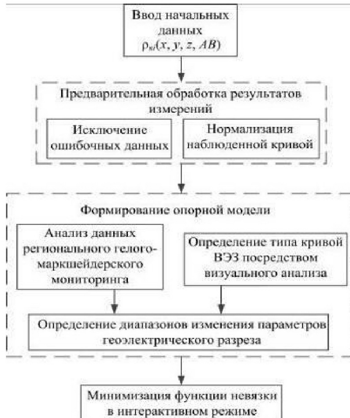
Рис. 1. Алгоритм интерактивной интерпретации данных вертикальных электрических зондирований
