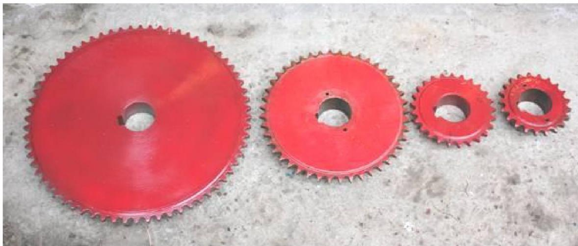
Рис. 3. Звездочки к приводным роликовым цепям, использовавшиеся при постановке эксперимента
