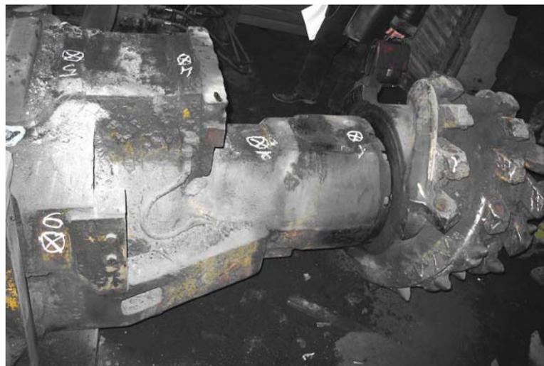
*Рис. 2. Исполнительный орган проходческого комбайна КСП-33*
