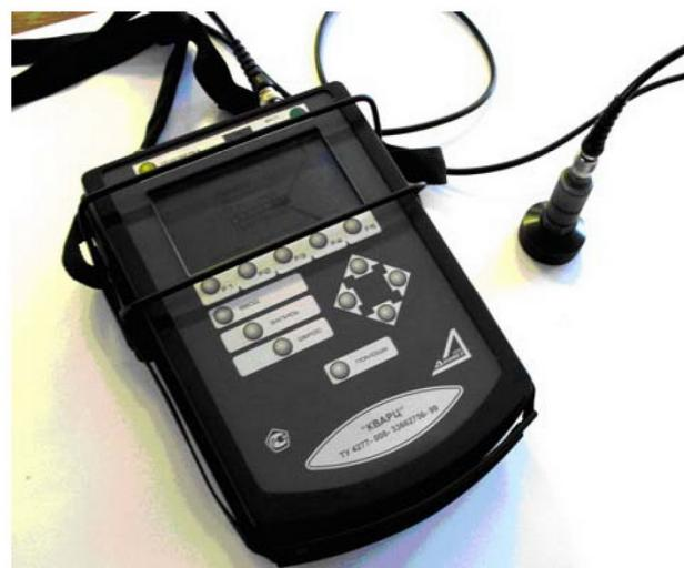
Рис.3. Виброанализатор «КВАРЦ»
