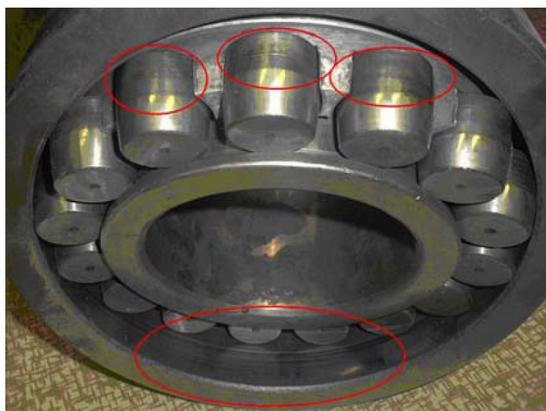
Рис. 2. Односторонний износ поверхностей качения
