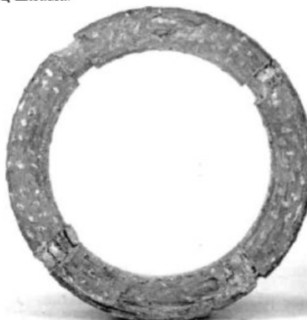
Рис. 1. Алмазная коронка с промывочными каналами, перекрытыми шламом
