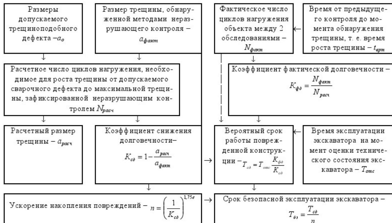
Рис. 2. Схема оценки остаточного ресурса (срока безопасной эксплуатации) металлоконструкций горных машин по скорости роста трещин
