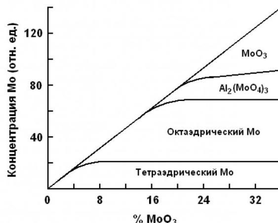
Рис. 1. Распределение различных форм Mo (VI) в окисленных алюромомолибденовых катализаторах, прокаленных при 500 °C в течение 16 ч, в зависимости от содержания  $\text{MoO}_3$  [8]
