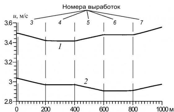
Рис. 4. Изменение скорости потока в выработках при нормальном (1) и реверсивном (2) режимах проветривания
