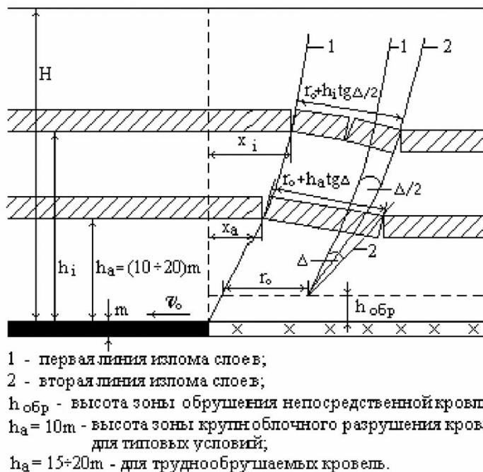
Рис.2. Схема формирования в подрабатываемом массиве линий излома слоев и вторичных шагов крупно-блочного обрушения основной кровли на разрезе по простирианию при установившемся режиме сдвижения кровли
