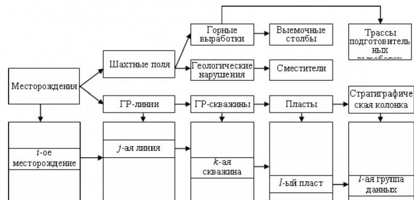
Рис. 2. Структурная модель горно-геологических данных
