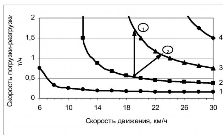
Рис. 5. Кривые количества рейсов за смену как функция скорости движения и скорости погрузки-разгрузки
