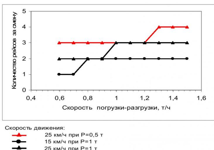
Рис. 6. Зависимости количества рейсов за смену от скорости погрузки-разгрузки для объемов перевозок 0,5 и 1 т при скорости движения автомобиля 15 и 25 км/ч
